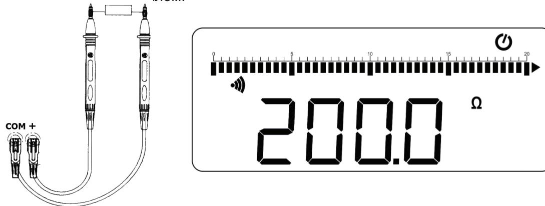
**ВНИМАНИЕ!** Во избежание возможного повреждения прибора или проверяемого оборудования перед выполнением «прозвонки» цепи и измерением сопротивления обязательно выключите питание проверяемого оборудования и полностью разрядите все имеющиеся в нем высоковольтные конденсаторы.
